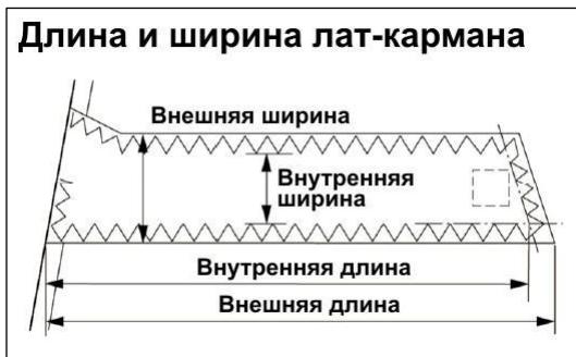
(b) ВНЕШНЯЯ [OUTSIDE]: Наибольшее расстояние между **шкаториной паруса** и крайней внешней оконечностью **лат-кармана**, измеренное параллельно оси кармана. Влиянием любого местного расширения для вкладывания латы следует пренебречь.
