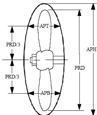
APT и APB — максимальные ширины отверстия выреза, измеренные параллельно оси вала на расстоянии не менее  $PRD/3$  выше и ниже оси вала
