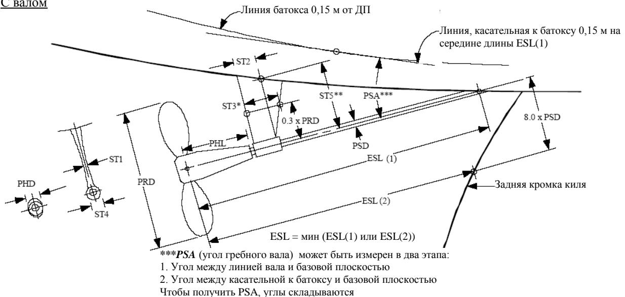
\***ST3** — максимальная ширина кронштейна, измеренная параллельно валу не более чем на  $0,3 \times PRD$  выше оси вала
